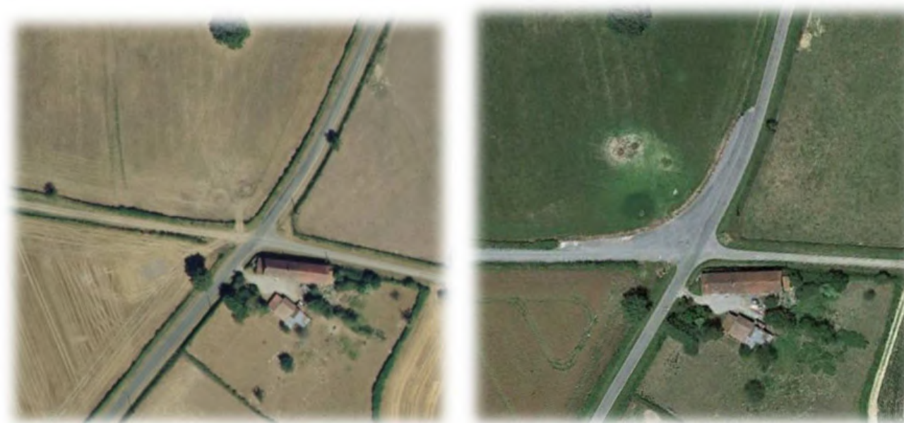
Illustration 1 - Exemple d'un aménagement de virage pour l'accès à un chantier de parc éolien
