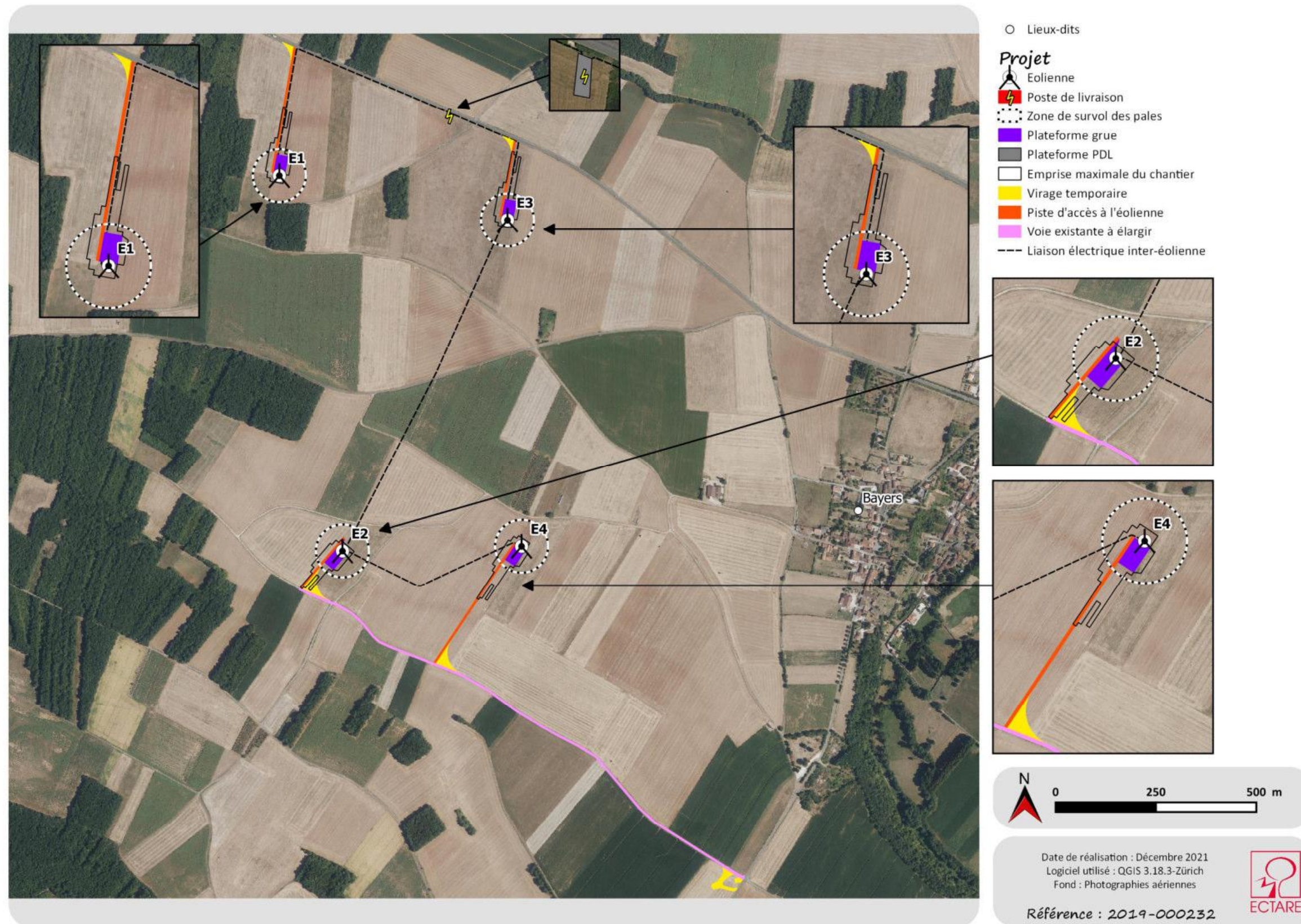
Carte 1 - Principaux éléments constitutifs des éoliennes du projet (© ECTARE)
